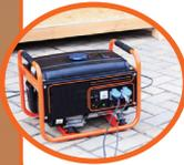
Use el generador al aire libre, lejos de los edificios, para que el monóxido de carbono (CO) no se acumule ni penetre en los edificios y produzca envenenamiento por CO.
